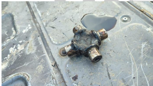
CRUCETAS DEL TOMA FUERZA
