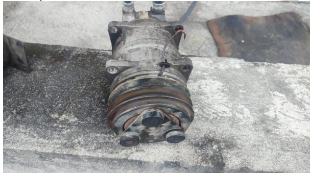
Compresor de aire acondicionado
