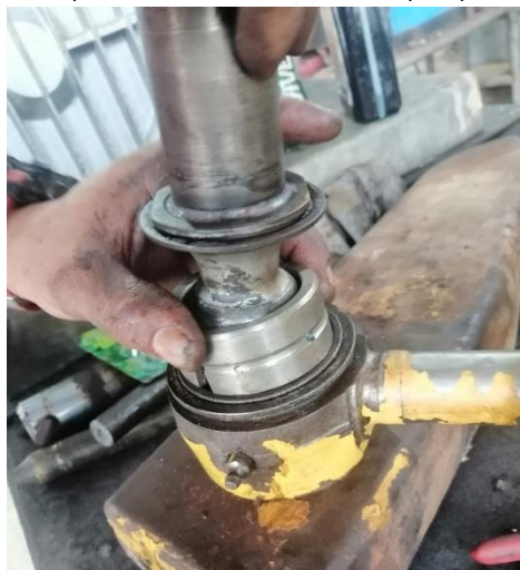
Reemplazar rotulas inferiores y superiores
