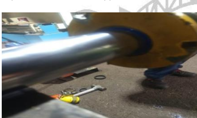
Reparación de brazos del ripper
