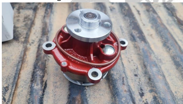
Bomba de agua
