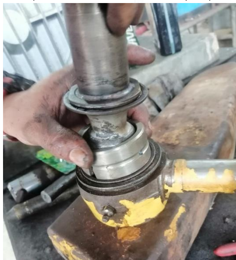
Reemplazar rotulas inferiores y superiores
